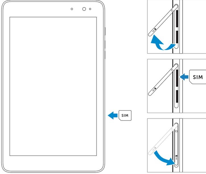
تنبيه: قد يؤدي إدراج بطاقة SIM غير متوافقة، مثل بطاقة nano-SIM، داخل فتحة بطاقة micro-SIM إلى تلف البطاقة أو الكمبيوتر اللوحي، وتلف البيانات المخزنة على البطاقة.
