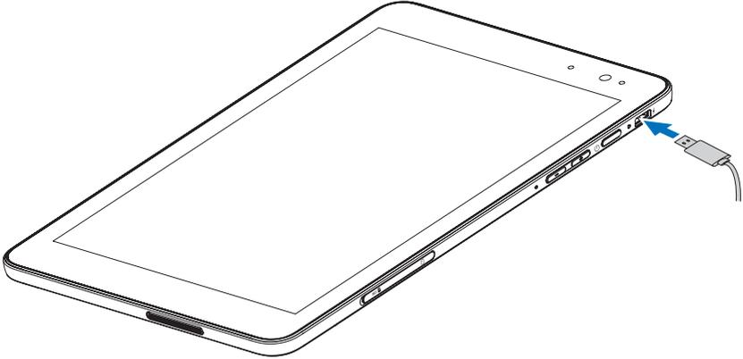
٣ توصيل مهائى الطاقة بمخرج كهربائى و شحن الجهاز اللوحي حتى تصبح البطارية مشحونة بالكامل.
