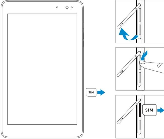
⚠ تنبيه: قد يؤدي إزالة بطاقة micro-SIM عند تشغيل الكمبيوتر اللوحي إلى فقدان البيانات أو تلف البطاقة. تأكد من إيقاف تشغيل الكمبيوتر اللوحي أو تعطيل اتصالات الشبكة.
